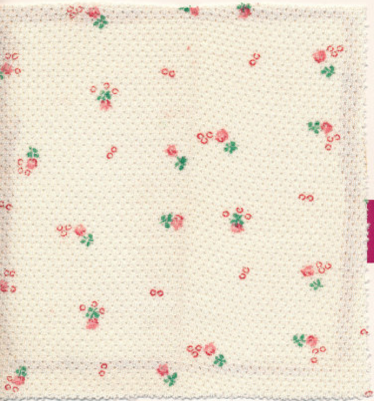
Feinrippware bedruckt, Einsatzgebiet: Untertrikotagen Material: 80 % PIVIACID-Faser, 20 % DEDERON-Faser.
