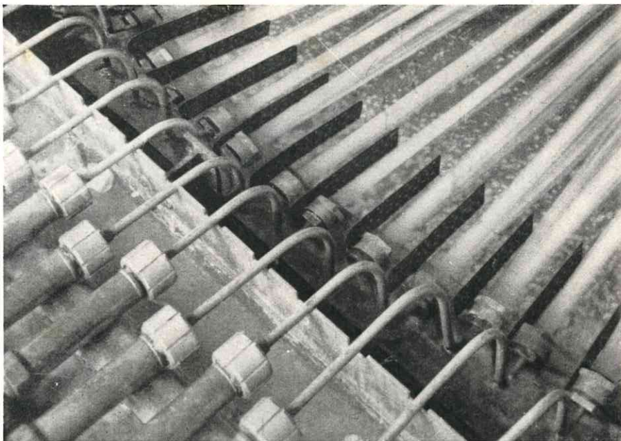
Le processus de fabrication de la fibre PC: Le filage
