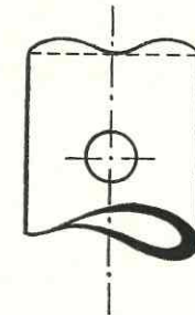
Bild 17 Kronenartige Ausbildung des Flyerflügelkopfes
