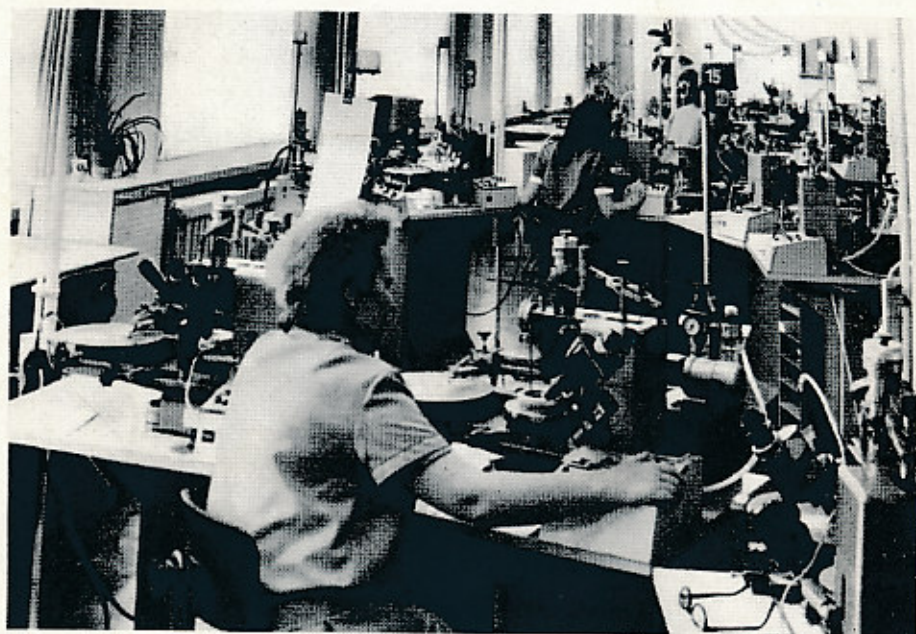
Halbautomatisches Bohren von Stahlspinndüsen
