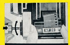
2. Patrone mit unbelichtetem Film in den Patronenraum (28) einlegen. Knopf der Rückspulkurbel (14) mit leichtem Drehen zurückdrücken: Der Mitnehmer der Rückspulachse (27) muß in den Patronenkern eingreifen.
