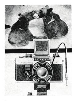
2. Das Sucherbild ist in allen Suchereinsätzen (Lichtschachteinsatz, Prismeneinsatz und TTL-Prismeneinsatz) auch bei nicht gespanntem Verschluß sichtbar (Rückkehrspiegel). Das Signal im Sucherbild zeigt an, daß die Kamera nicht aufnahmebereit ist und daß vor der nächsten Belichtung der Spannhebel (9) betätigt werden muß. (Bildbeispiel: Sucherbild im Prismeneinsatz.)
