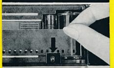
3. Filmanfang im Filmkanal (29) bis zur grünen Markierung (35) ziehen und mit der (unteren) Perforation von oben her unter das Filmböckchen (33) und somit über die Filmtransportrolle (32) bis zum Anschlag schieben. Fangbügel der Aufwickelspule (34) darf nicht nach oben stehen! Ist das der Fall, dann Spule am gerändelten Spulenteller drehen, bis die Bügel seitlich stehen.
