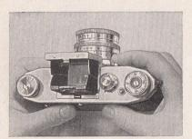
nach Ablauf des Verschlusses wieder freigegeben wird. Bei der Verschlußstellung "B" wird der Auslöseknopf solange eingedrückt, wie belichtet werden soll. Soll ein Drahtauslöser benützt werden, so ist im Auslöseknopf ein Gewinde vorgesehen, in das sich der Drahtauslöser einschrauben läßt. Beim Einschraubvorgang ist zu beachten, daß der Drahtauslöser leicht eingeführt wird.
