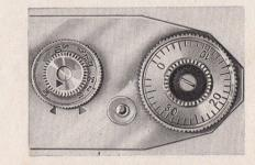
Bei den Belichtungszeiten von  $^1\!/_{10}$  bis  $^1\!/_2$  sec. muß der Zusatzknopf mit seinem roten Dreieck nach dem roten Dreieck der Deckkappe zeigen.
