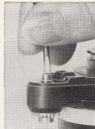
Zum Überprüfen der Schärfentiefe bei Einstellversuchen Auslöseknopf (3) nur so weit hineindrücken, daß wie gewünscht abgeblendet, der Verschuß aber noch nicht ausgelöst wird. – Damit der Verschußauslöseknopf (17) stets bis zum Auslösen des Verschlusses hineingedrückt werden kann, ist die Stellschraube der Auslöseeinrichtung des Objektivs mit einem Schraubenzieher auf die nötige Länge einzustellen. – In den Auslöseknopf (3) kann ein Drahtauslöser mit langem Druckstift eingeschraubt werden.
