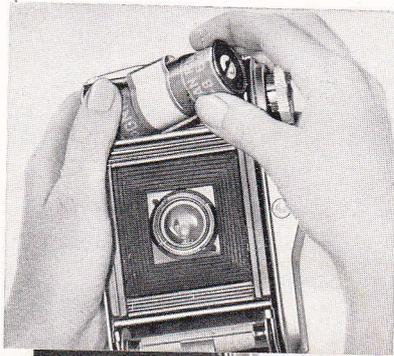
Leere Spule nun wieder auf die andere Seite bringen. Hierzu den Spulenhalter herausschwenken, und die Spule — im umgekehrten Weg wie auf Seite 5 beschrieben — entnehmen und in die andere Spulen-kammer legen — runde Bohrung auf den feststehen- den Zapfen setzen.
