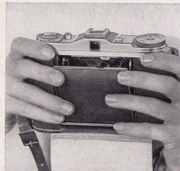
Mit festem Druck auf den angelenkten Laufboden wird die Camera unter hörbarem Einschnappen geschlossen.
