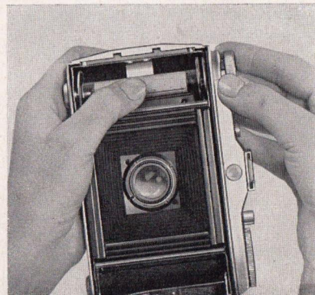
**Die Leerspule in die Spulenkammer drücken**
