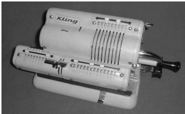
Abb. 23: Kling -Modell F 330, Kapazität 9 x 8 x 13, Eingabeanzeige, Rückübertragung, S/N 68994; Hersteller: TRS , Zagreb.
