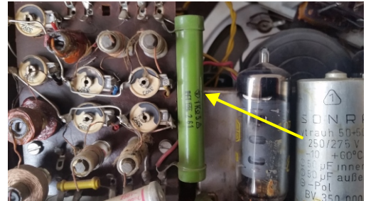
Ausschnitt Leiterkarte „Ilmenau 210“ mit Kohleschichtwiderstand
