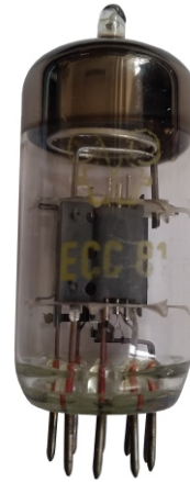
Elektronenröhre ECC81 - Doppel-Triode im Radio „Sonor“
