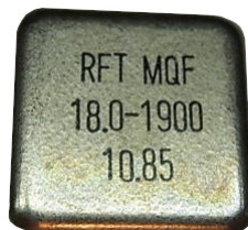
Monolithisches Frequenzfilter (Quarzfilter) MQF 18.0-1900
