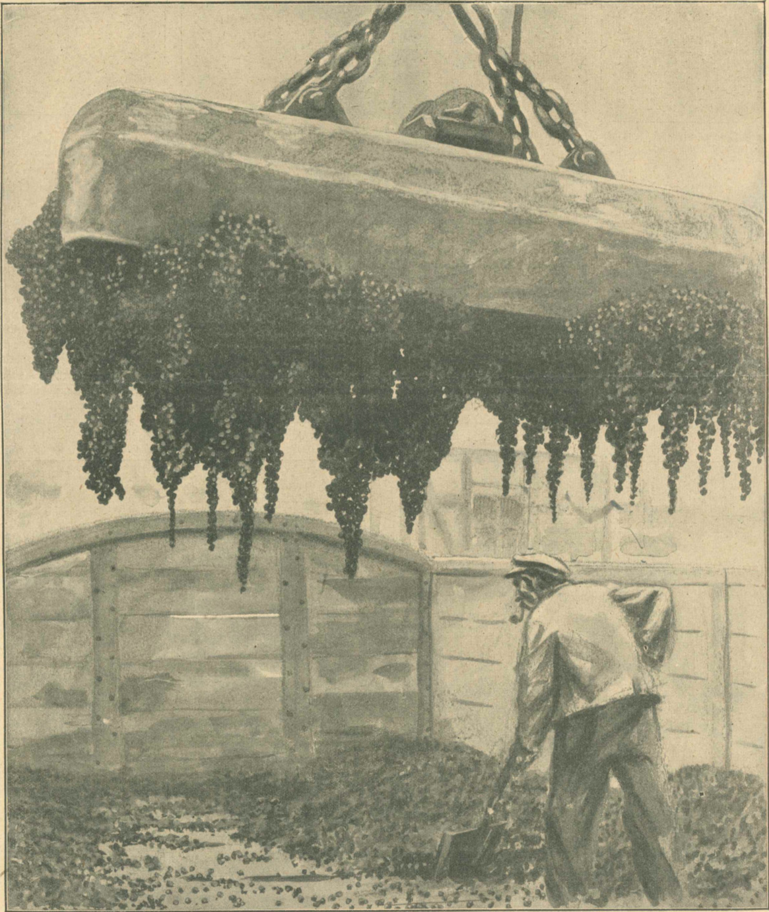
Verarbeitung von Kriegsmaterial für Friedenszwecke in den Spandauer Reichswerken: Transport von Schrapnellkugeln zum Schmelzofen mit Hilfe eines Riesen-Elektromagneten.
