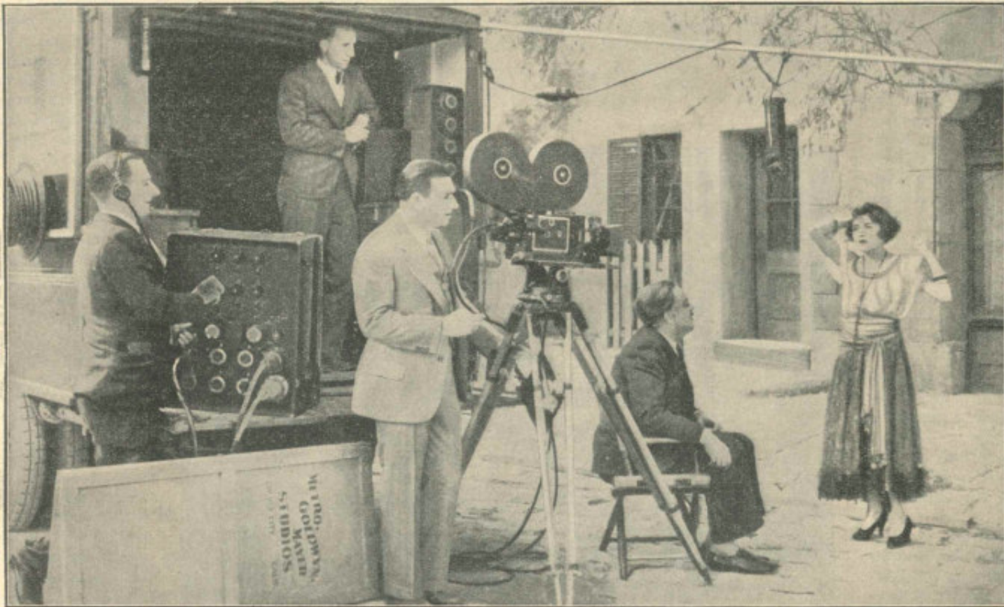
Eine Sprechfilm-Aufnahme im Freien: Man sieht die komplizierten Aufnahme-Geräte; das Mikrophon hängt über dem Kopf der Hauptdarstellerin (Nenée Adorée). Die Gefahr für eine solche Aufnahme liegt darin, daß eine am Mikrophon vorbeifliegende Biene oder Fliege die Szene verderben kann.
