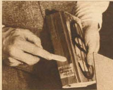
Der Leinenstreifen wird mit einem Falzbein glatt und festgestrichen
