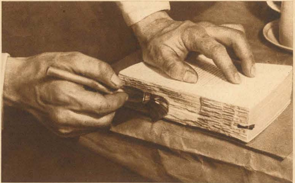
Der alte Buchdeckel wird abgerissen, die alten Leimreste sorgfältig abgekratzt. Dann wird neu geleimt und falls der alte Deckel unbrauchbar ist, ein Leinenstreifen aufgeklebt
