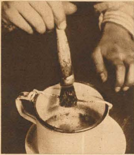
Wichtig ist die Leimzubereitung. Nach 24-stündigem Einweichen in kaltem Wasser wird der Leim im Wasserbad gekocht und warm und dünnflüssig verarbeitet
