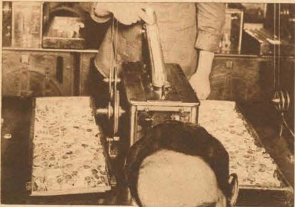
Die geprägten Stücke werden durch Sortiermaschinen geleitet. Zu leichte oder zu schwere Stücken werden ausgeschieden und wieder eingeschmolzen
