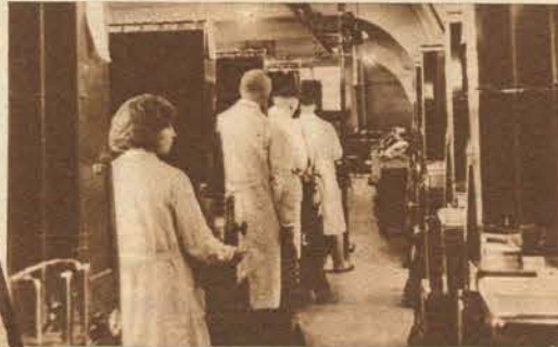
An den Lochkartensortiermaschinen. Die Maschinen „fühlen“ auf den Karten Datum, Kontonummer, Debet, Kredit, Bargeld, Effekten, deutsches Geld und Fremdwävaluta
