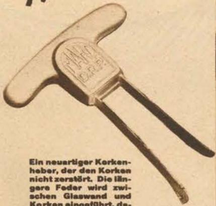
Ein neuartiger Korkeheber, der den Korken nicht zerstört. Die längere Feder wird zwischen Glaswand und Korken eingeführt, danach auch die kurze. Durch Hin- und Herbiegen werden beide Federn bis zum Griff des Hebers eingeschoben. Durch drehendes Ziehen entfernt man den Korken. Preis 1 Mk.
