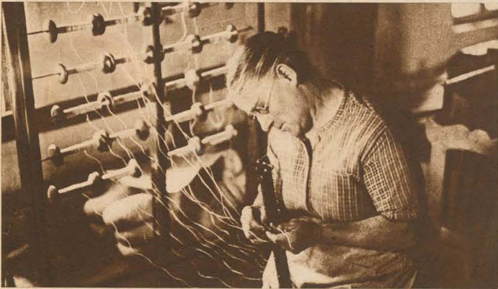
Der Faden wird an einer altmodischen Trommel gespult
