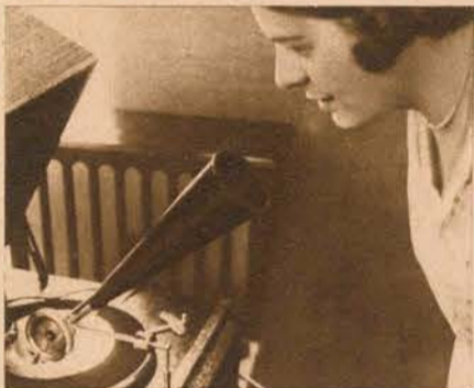
Akustischer Aufnahmeapparat zur Selbstherstellung von Schallplatten, der an jedem Grammophonapparat angebracht werden kann
