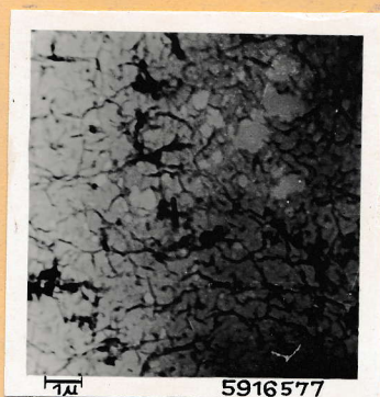
Abb.24 Übermikroskopaufnahme einer Sb_2S_3 -Schicht (Kohleabdruck) von einem Endikon mit einem Signal von 0,07 \mu A bei 50 lx auf der Fotokathode.
