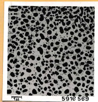
Abb.16 Übermikroskopaufnahme einer Sb_2S_3 -Schicht, die im Hochvakuum auf eine Kohlefolie gedampft wurde. Durch Elektronenbeschuß stark umgewandelt.
