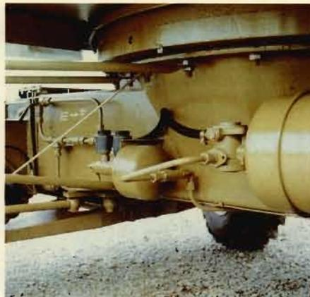
Unterwagen mit Bremskraftverstärker und Anhängerbremsventil
