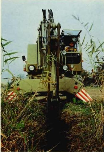
Einsatz mit montiertem Dränlöffel
