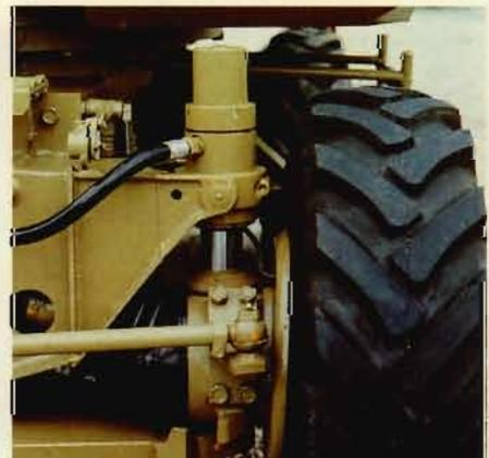
Hydraulische Pendelachse und Spurstange
