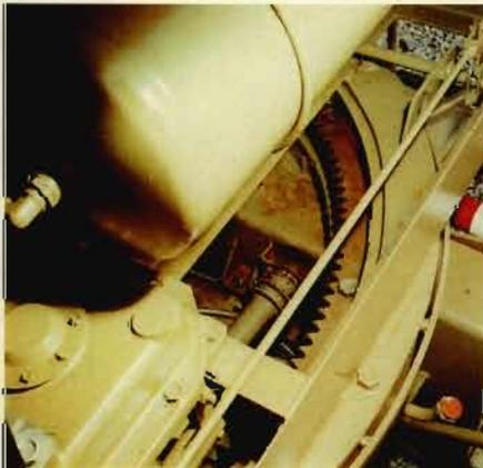
Innenansicht mit Drehwerk und Kugeldrehkranz
