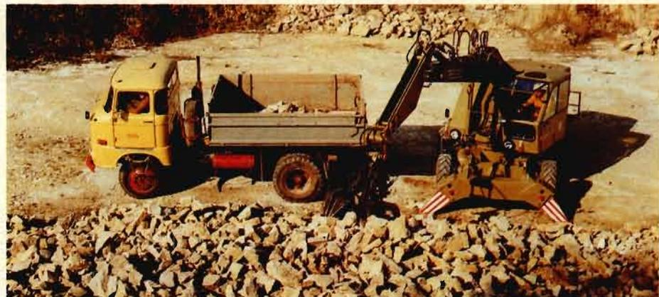
Einsatz des Mehrschalengreifers beim Beladen eines LKW's
